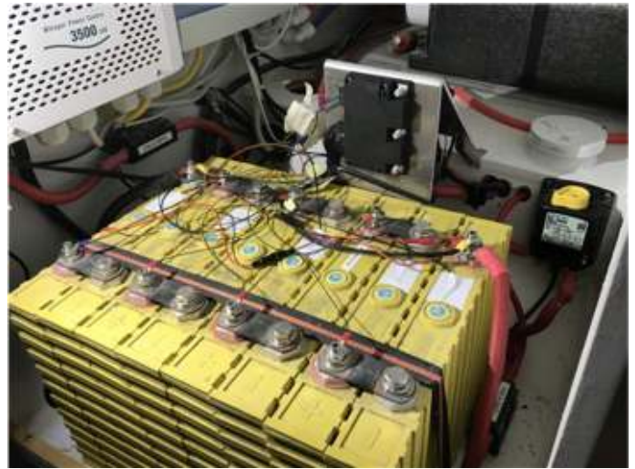
Fig. 6. Een 24 volt systeem met Winston cellen en externe BMS.
