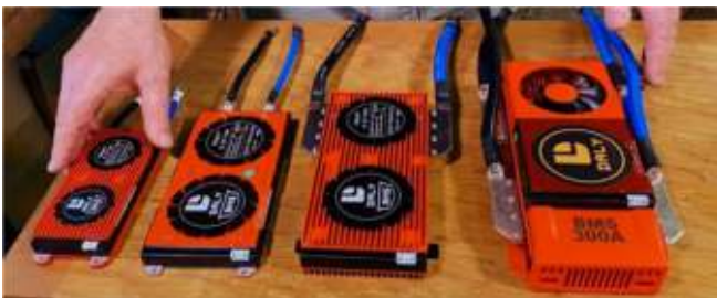
Fig. 5. Externe smart BMS, veel verschillende uitvoeringen.
