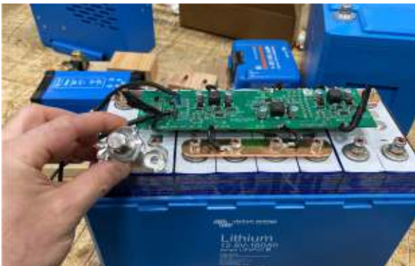
Fig.1 Voorbeeld van een LFP accu met ingebouwd BMS
